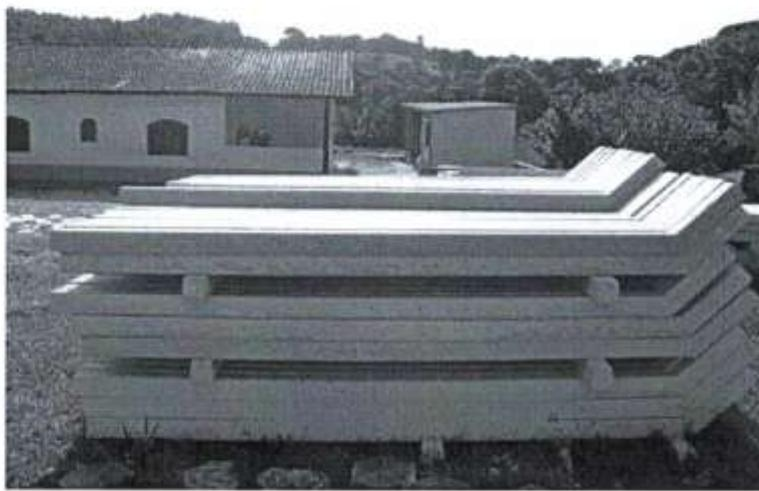
Mourões de concreto ou palanques são peças pré-moldadas utilizadas na confecção de cercas.
